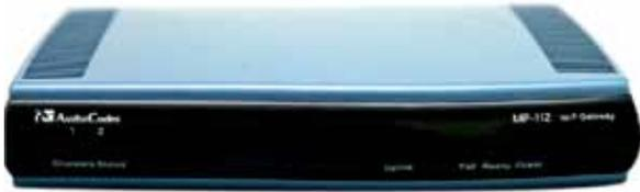
**Bemerkung:** Der Analogadapter wurde mit diversen im Markt erhältlichen Faxendgeräten auf deren Kompatibilität zueinander getestet. Hierbei wurde festgestellt, dass einige, hauptsächlich Kombinations-Faxendgeräte, Faxweichen sowie einige Canon-Faxgeräte nicht den Fax-Standard (ITU T.30) einhalten und sich somit nicht mit diesem Fax AFA kompatibel verhalten.
